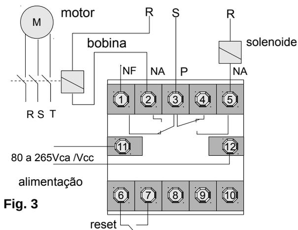
Rele 1(bornes 1,2 e 3) Programador Horário, Rele2 (Bornes 3,4 e 5) Temporizador Cíclico.
